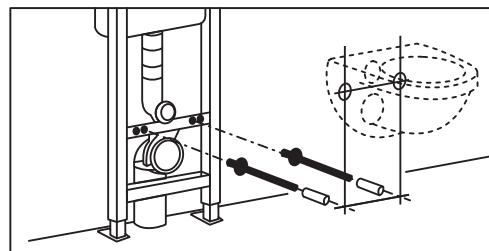
3. Обработайте манжеты и выпуск унитаза технической мазью и направьте отвод изделия в фановую трубу. На выпуск инсталляционной системы наденьте соединительную манжету.
