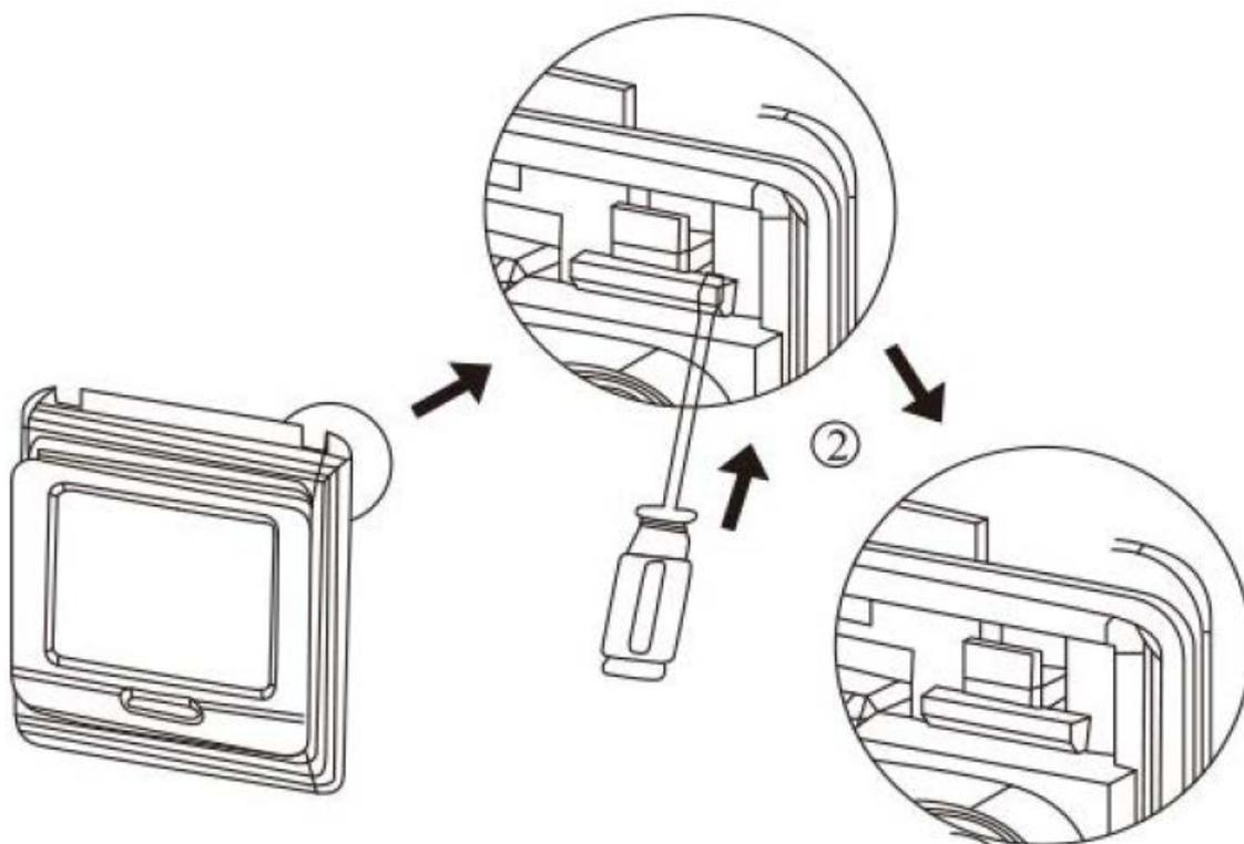
3) Установите опорную пластину в розетку с помощью отвертки.
