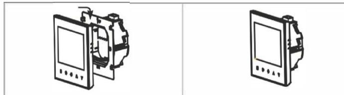
Шаг 5. Закрепите корпус термостата и монтажную панель вращением.
