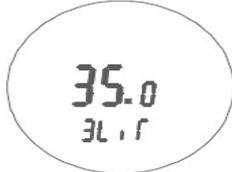
3. LIT: Ограничение температуры пола. С помощью кнопок + и - установите для ограничения максимальную температуру для пола. Предел ограничения  $5-60^{\circ}\text{C}$ . Нажмите "📖" для следующего шага
