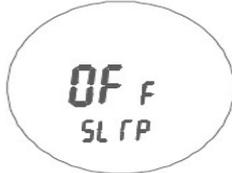
5. LTP: Режим антизамерзания при выключенном терморегуляторе. С помощью кнопок + и - выберите режим. Нажмите "📖" для следующего шага
