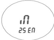
2. SEN: Выбор датчика. С помощью кнопок + и - выберите режим работы 1N : датчик воздуха; OUT: датчик пола, ALL: оба датчика (датчик пола ограничительный). Нажмите "📖" для следующего шага
