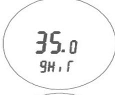
9. HIT: Установка максимальной температуры. С помощью кнопок + и - установите максимальную температуру. Диапазон  $35-90^{\circ}\text{C}$ . Нажмите "📖" для следующего шага.
