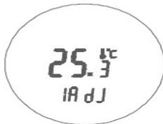
1. ADJ: Калибровка температуры. С помощью кнопок + и - откалибруйте температуру. Предел калибровки  $\pm 9,3^{\circ}\text{C}$ , нажмите "📖" для перехода в следующий пункт подменю расширенных настроек
