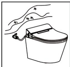
Не подключите подвод воды к источнику грязной или промышленной воды.
