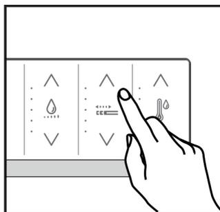
При активной функции «Обмыв» нажмите  $\blacktriangle$ , чтобы форсунка выдвинулась вперед; нажмите  $\blacktriangledown$ , чтобы форсунка вернулась в исходное положение.
