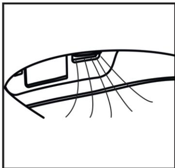
При активной функции «Сушка» открывается специальное отверстие, из которого исходит поток комфортного теплого воздуха.
