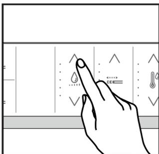
При активной функции «Обмыв» нажмите  $\blacktriangle$ , чтобы увеличить интенсивность потока воды;  $\blacktriangledown$  – чтобы уменьшить напор воды.
